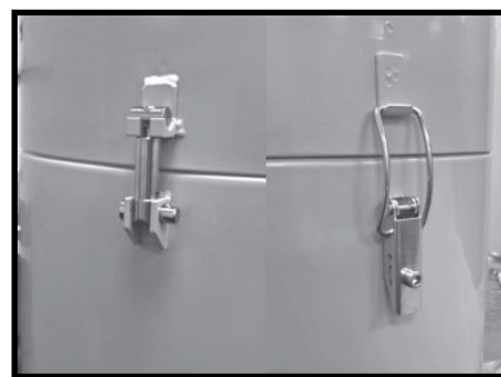
Krok 18. Znovu sestavte jednotku. Zajistěte, aby bezpečnostní západka a spona byly bezpečně upevněny.
