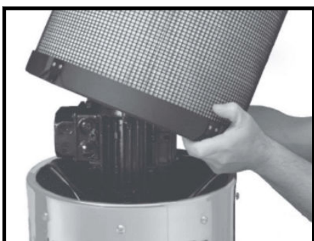
Krok 4. Zkontrolujte dodatečný filtr (pokud je namontován) a v případě potřeby jej vyměňte.
