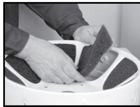
Krok 12. Odstraňte starý tlumič a namontujte nový tlumič.
