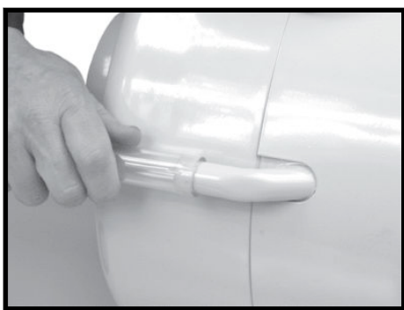
Krok 7. Namontujte zpětnou trubku oleje a polohovou trubku pro vypuštění oleje zpět do skříně stroje, jímka nebo sběrná nádoba.
