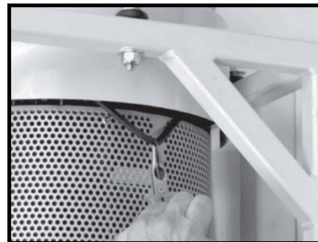
Krok 3. Odstraňte staré těsnění.
