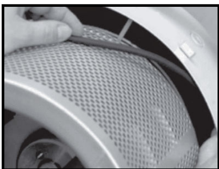
Krok 16. Namontujte nové těsnění.
