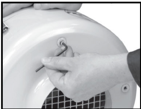
Krok 1. Demontujte čtyři vložkové šrouby v základně jednotky.
