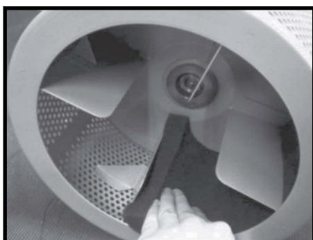
Krok 8. Namontujte nové bubnové podložky.
