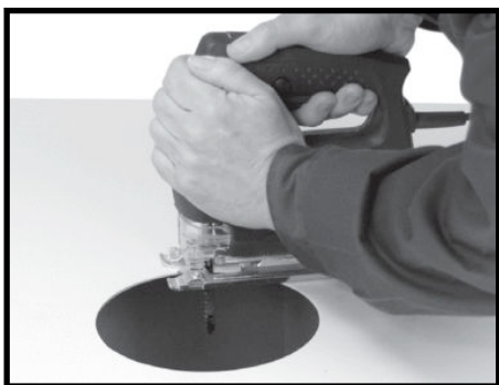
Krok 4. Vyřízněte odsávací otvor v krytu stroje.
