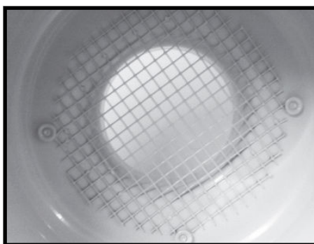
Krok 17. Zkontrolujte, zda je přívodní mřížka čistá.
