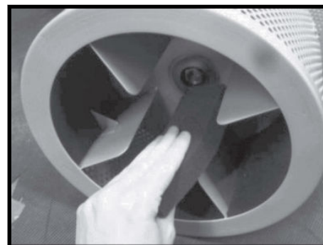
Krok 6. Odstraňte staré bubnové podložky.
